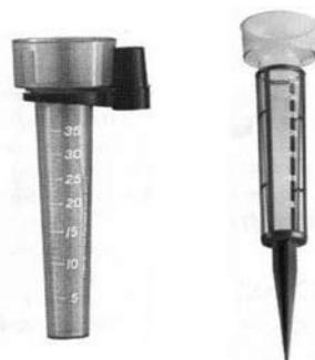
Пластиковые осадкомеры выполнены в комплекте с держателем для крепления на штыре, либо в комплекте с корзинкой для установки в грунте.
