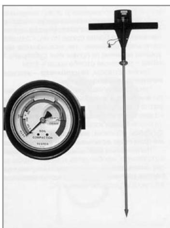
**Пенетрометр** - прибор для измерения плотности почвы от поверхности до глубины в 45 см, по горизонтам.
