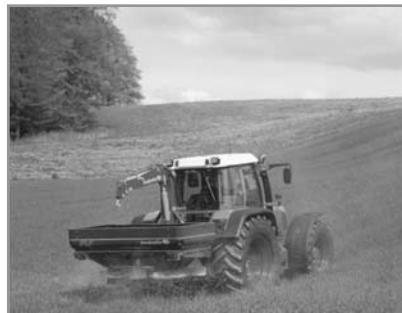
**Распределители серии M-2 base и L-2 plus, могут быть оборудованы гидроманипулятором BM 1250, для загрузки удобрений из «Биг-бэгов»**
