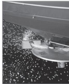
работы «от границы» поля – переключаем трансмиссию и закрываем правый выход бункера. За счёт универсальной конструкции лопаток, применяемых при нормальном и поворотном разбрасывании без установки дополнительных узлов, агрегатов и дополнительных регулировок достигается простота и точность в эксплуатации.
