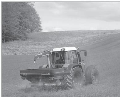
**Распределители серии M-2 base и L-2 plus, могут быть оборудованы гидроманипулятором ВМ 1250, для загрузки удобрений из «Биг-бэгов»**
